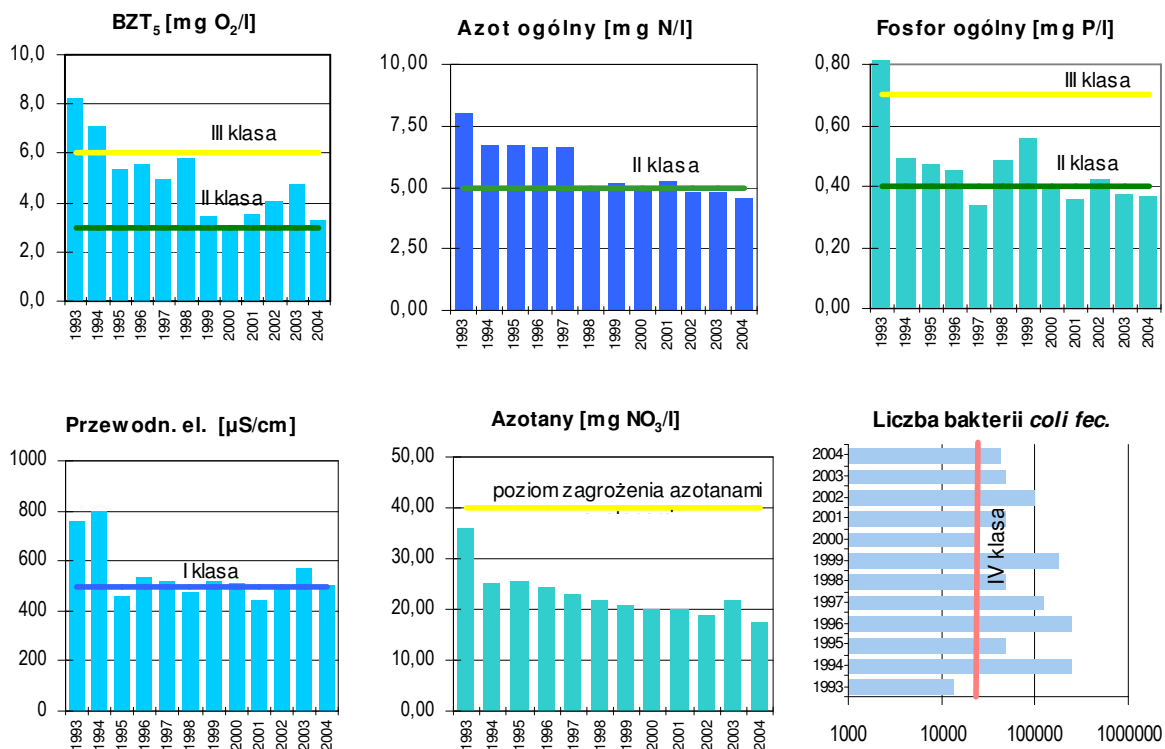
Wykres 11. Przebieg zmian stężeń wybranych wskaźników zanieczyszczenia dla rzeki Ścinawki w przekroju ujściowym (0,5 km)
